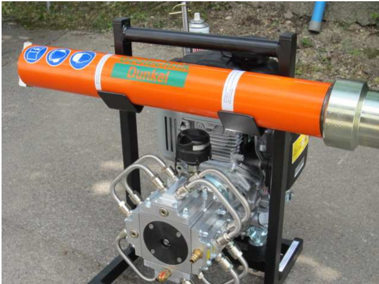
Slika 6 - dinamični penetrometer PR.13
